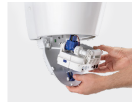
↑ La unidad de control contiene el control infrarrojo, la fuente de alimentación y la válvula de solenoide y se puede extraer con una sola mano.
